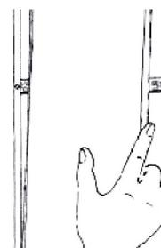
4. Панель вставляется в профиль, снизу вверх, причем большая крепежная полка на самой панели должна быть расположена в сторону движения монтажа. После того, как панель вставлена, закрепляем её кляймерами к монтажным планкам.
