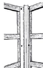
2. Монтажные планки обрешетки крепятся к стене или потолку шурупами, гвоздями.
